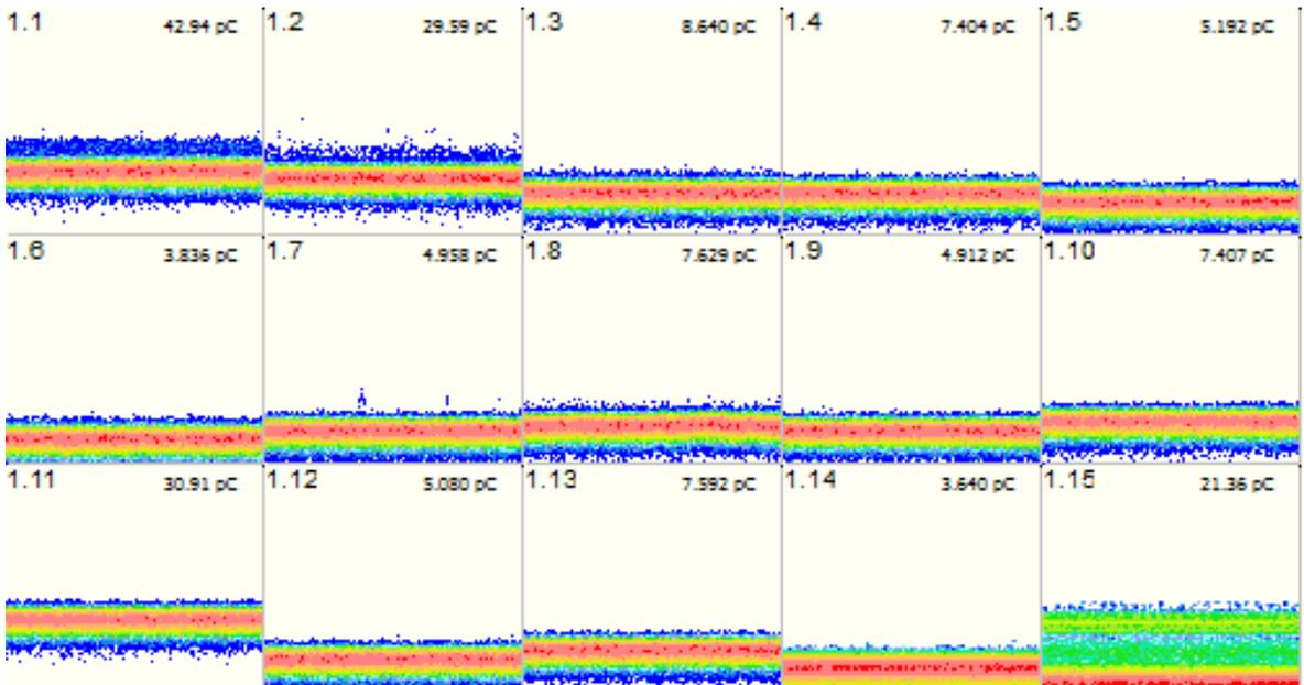
Fig.32 PD measurement at 180kV with 15 MPD units - 1.1=coupling capacitor, 1.3=joint 1-2, 1.4=joint 2-3, 1.5=joint 3-4, 1.6=joint 4-5, 1.7= joint 5-6, 1.8= joint 6-7, 1.9=joint 7-8, 1.10=joint 8-9, 1.11=joint 9-10, 1.12=joint 10-11, 1.13=joint 11-12, 1.14=joint 12-13, 1.15=end terminal GIS
