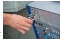
Anschluss der Sensoren am Meßgerät
